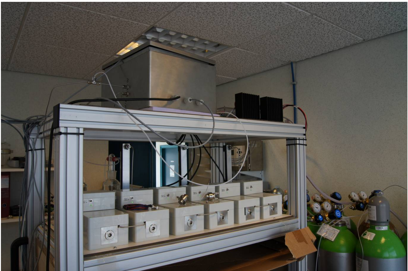
Figuur 8: Voorzijde met de 6 permeatie-ovens en bovenop de ingebouwde MGA sensor.
